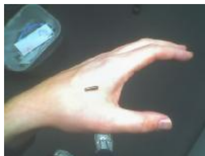
Figuur 8 RFID chip voor implantatie (Graafstra, 2005). http://amal.net/rfid.html
